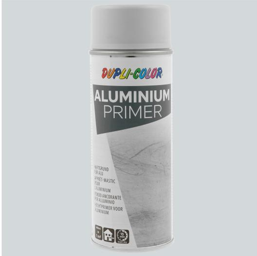
Primer specifico per superfici in alluminio a base di resina acrilica speciale. Legante eccellente tra il substrato in alluminio e lo smalto coprente successivo. Può essere utilizzato anche per zinco e rame a certe condizioni, se si desidera una verniciatura successiva. Può essere rivestito con tutte le vernici acriliche, alla nitro e a base di resina sintetica essiccanti all'aria, come con DUPLI-COLOR Auto-Spray o DUPLI-COLOR ALL SEASON.
